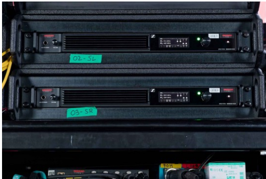
Die Spectera Base Stations der session pro GmbH wurden auf der Buffet Crampon Main Stage genutzt
