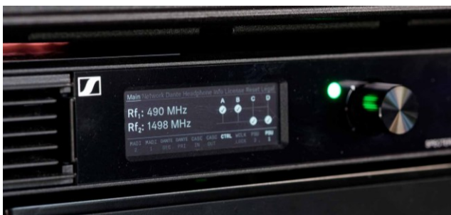
Die Spectera Base Station in der „Kraut & Ruabm Arena“ wurde im UHF- und im 1,4 GHz-Bereich betrieben
