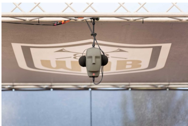
Ein Neumann KU 100 Kunstkopf wurde als binaurales Stereomikrofon eingesetzt
